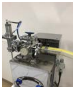
ホッパーからの吸入とストレージタンクからの直接吸入の2系統が選択できます。
