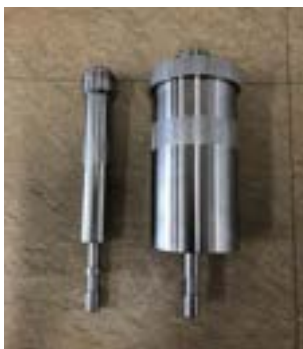
充填量によりポンプ径を変更！ 写真左φ20、右φ80
